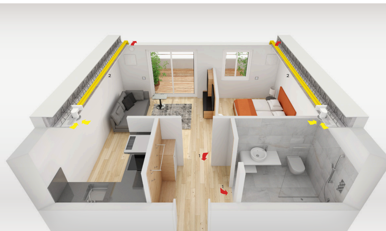
1 U vnitřních dveří je nutno počítat s volnými otvory k proudění vzduchu mezi místností s přívodem a místností s odvodem vzduchu, jako např. se spárami dveří. 2 DŮLEŽITÉ UPOZORNĚNÍ: ZÁSADNĚ JE VŽDY NUTNO VĚST 2 HADICE FLEXIBILNÍHO POTRUBÍ DO MÍSTNOSTI PŘÍVODU A ODVĚTRÁNÍ VZDUCHU!
